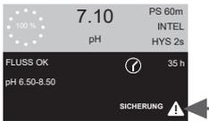
Dieser Alarm tritt ein, wenn die interne Sicherung der Platine durchgebrannt ist.
