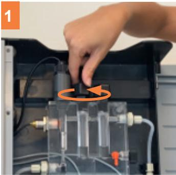
Schrauben Sie die Mutter des Anschlussstücks ab.
