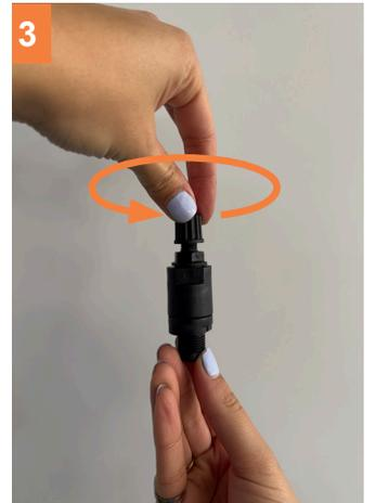
3 Schrauben Sie den Anschluss vom Injektor ab.
