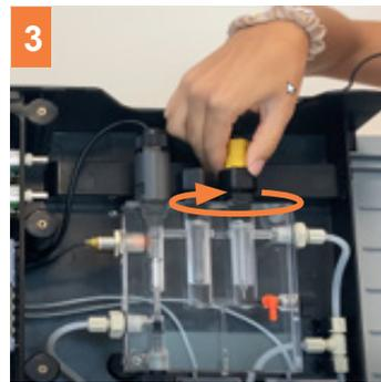
Ziehen Sie die Mutter des Anschlussstücks an, bis sie fest angezogen ist. Achten Sie darauf, dass sich das Kabel beim Einschrauben des Sensors nicht dreht.
