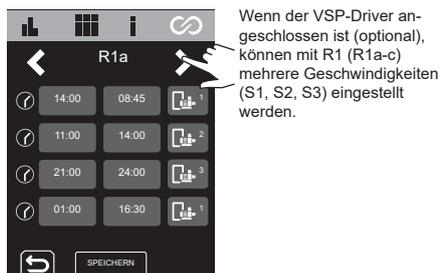
Wenn der VSP-Driver angeschlossen ist (optional), können mit R1 (R1a-c) mehrere Geschwindigkeiten (S1, S2, S3) eingestellt werden.
