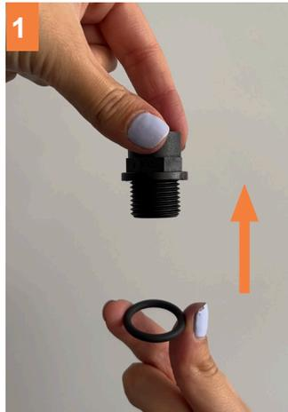
1 Setzen Sie den Dichtungsring auf das Gewinde des Adapters.
