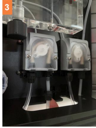
3 Schieben Sie das starre Rohr in den Auslass der Pumpe.
