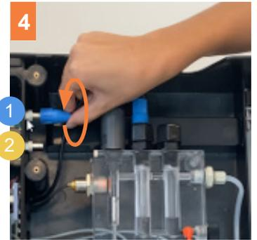
Schließen Sie den Sensor an den pH-Driver (Position 1) an.
