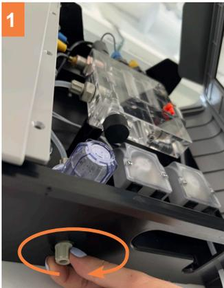
1 Schrauben Sie den Verbinder vom Eingangsanschlussstück (Anschluss zum Vorfilter) ab.
