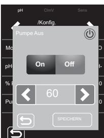
Bei eingeschalteter **PUMPE AUS-FUNKTION** (Standardeinstellung) stoppt das System die Dosierpumpe nach einer vorgegebenen Zeit in Minuten, auch wenn der pH-Sollwert nicht erreicht ist.
