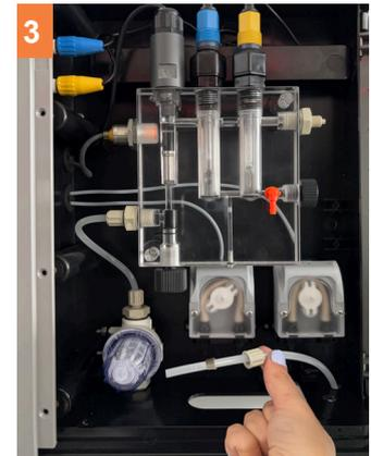
3 Setzen Sie den Anschluss und den Klemmring auf das starre (weiße) Rohr. **Achten Sie auf die richtige Ausrichtung laut Foto. Teil B ist in Teil A.**
