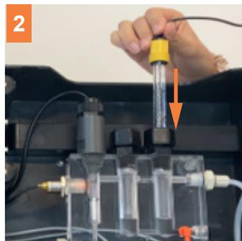
Setzen Sie den ORP-Sensor (gelb) in die rechte Aufnahme des Sondenhalters ein.
