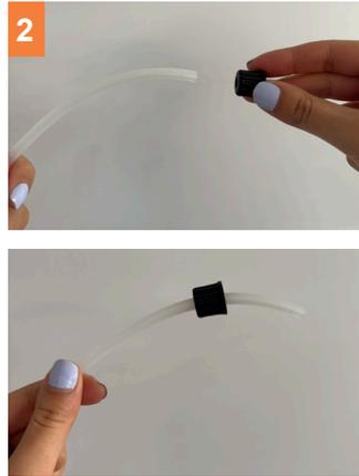
2 Stecken Sie den Anschluss auf das starre weiße Rohr (PE6X4).
