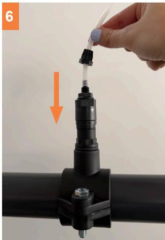
6 Stecken Sie das starre Rohr mit Anschluss in den Injektor.
