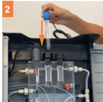
Setzen Sie den pH-Sensor (blau) in die linke Aufnahme des Sondenhalters ein.
