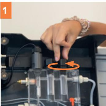
Schrauben Sie die Mutter des Anschlussstücks ab.
