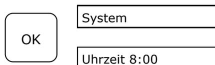
Die eingestellte Uhrzeit kann überprüft werden. Durch Drücken der OK-Taste kann der angezeigte Wert verändert werden.
