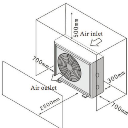
Installieren Sie die Wärmepumpe, wo man den besten Zugang zu warme Luft während der Badesaison haben.
