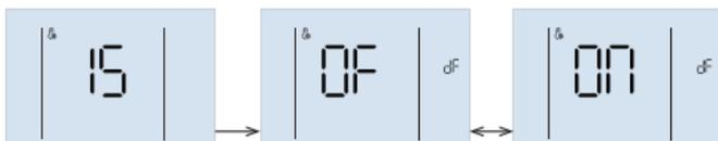
15 - Die manuelle Entfrosthofunktion wird nach der Entfrosthofung automatisch deaktiviert.
