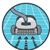
Externe Absaugung durch die Poolpumpe
