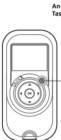
1. Drücken Sie einmal auf die An-/Aus-Taste. Daraufhin wechselt die Fernbedienung in den manuellen Richtungssteuerungs-Modus. Benutzen Sie die Richtungssteuerungs-Pfeile (siehe rechts), um die Bewegung des Roboters im Schwimmbad zu steuern
