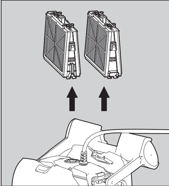
Öffnen Sie die Filter Abdeckungen, und entfernen Sie die Kartuschen von beiden Seiten des Roboters.
