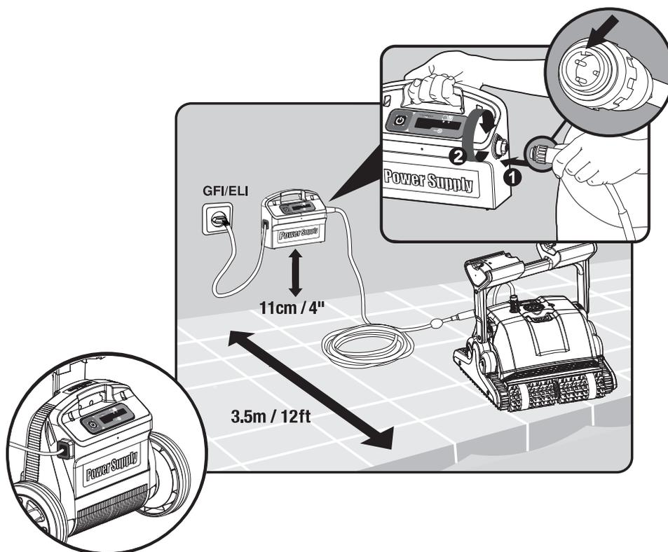
Verbinden Sie das Schwimmkabel mit dem Stromversorgungsgerät, indem Sie die Nut am Anschluss (1) ausrichten und den Stecker in das Stromversorgungsgerät stecken und dann im Uhrzeigersinn drehen (2). Stecken Sie das Stromversorgungsgerät in die Steckdose und stellen Sie es auf Position OFF.
