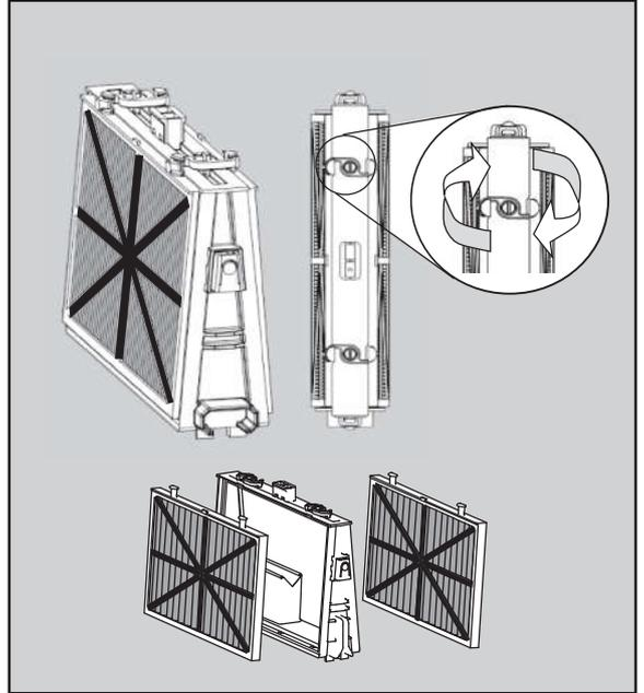
Öffnen Sie die Klammern und entfernen Sie die Filter.
