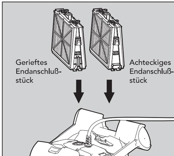
Installieren Sie den Grundrahmen mit den Filtern, entsprechend dem Diagramm.
