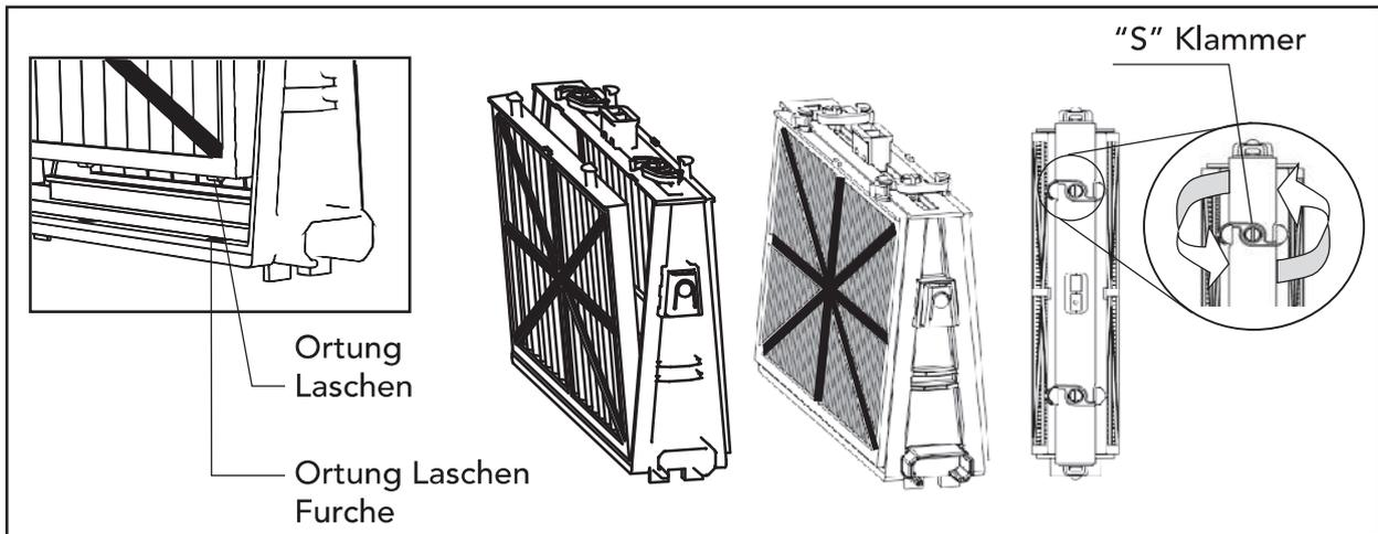
Wiedereinbau der Filterelemente: Legen Sie die Ortung Laschen, die sich am unteren Rand des Filterelementes befinden, in ihre Furchen auf dem Grundrahmen, und schließen Sie dann die "S"-Klammer.
