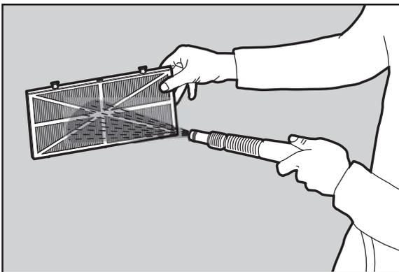
Reinigen Sie die Filter mit einem Wasserschlauch.
