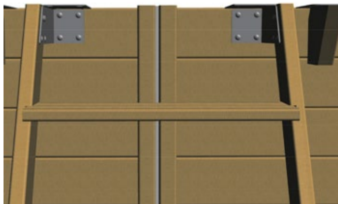
Abbildung 17 – Anbringen der Außentreppe am Becken
