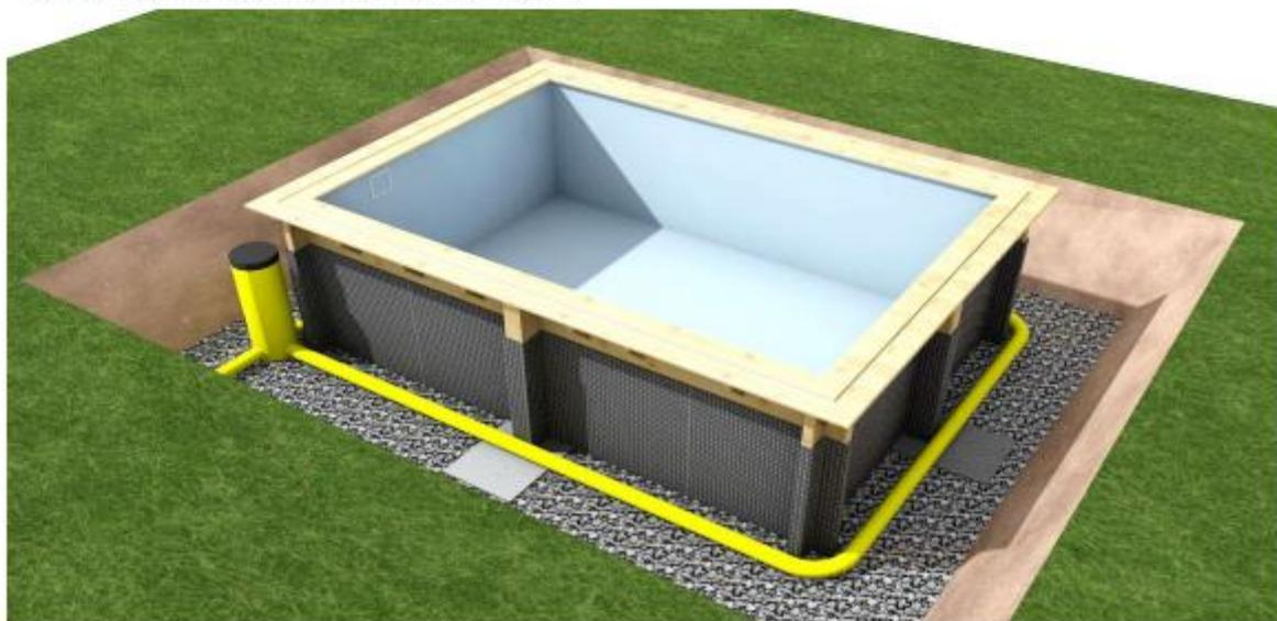
Die Grube, worin sich das Becken befindet, muss gleichmäßig mit dem Anstieg des Wasserspiegels befüllt werden.
