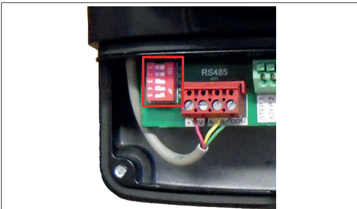
Position der Schalter zur Steuerung über iQPUMP
