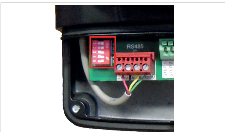
Position der Schalter zur Steuerung über die Benutzerschnittstelle
