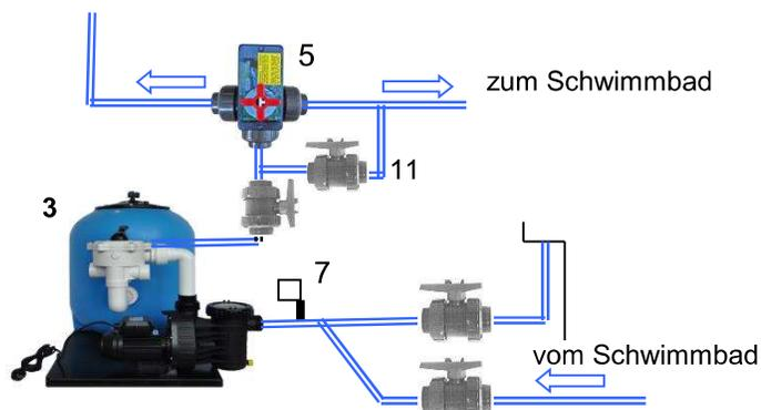
6. T-Stück für Vorlauf in die zum Becken führende Leitung einkleben. Kugelhahn (9) - Fallstrombremse - in die Vorlaufleitung kleben.
