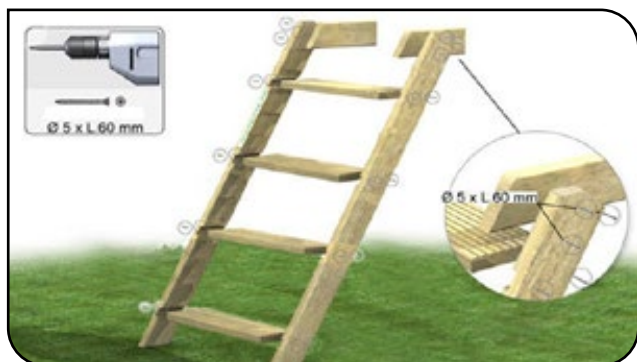
Figure 62 – Assemblage de l'échelle en bois
