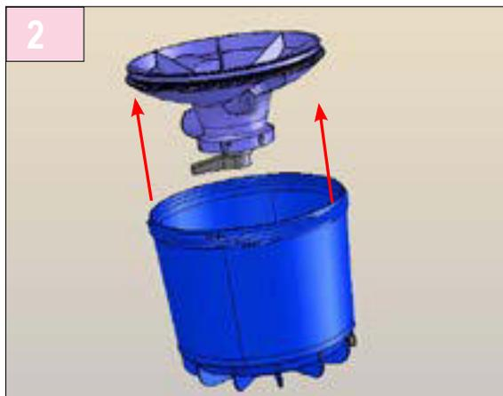
Entfernen Sie die Baugruppe Deckel/Ventil. (Diese Baugruppe wird umgedreht transportiert.)
