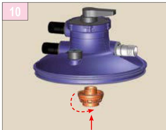
Montage des Diffusors: Positionieren Sie den Diffusor unterhalb seines Gehäuses, schieben Sie ihn gegen den Deckel und drehen Sie ihn, bis er komplett in die U-förmige Öffnung im Deckel hineinrutscht.
