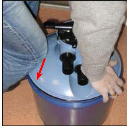
Drücken Sie den Deckel an einem Punkt auf den Filtertank. Halten Sie den Druck an diesem Punkt mithilfe Ihres Knies aufrecht.
