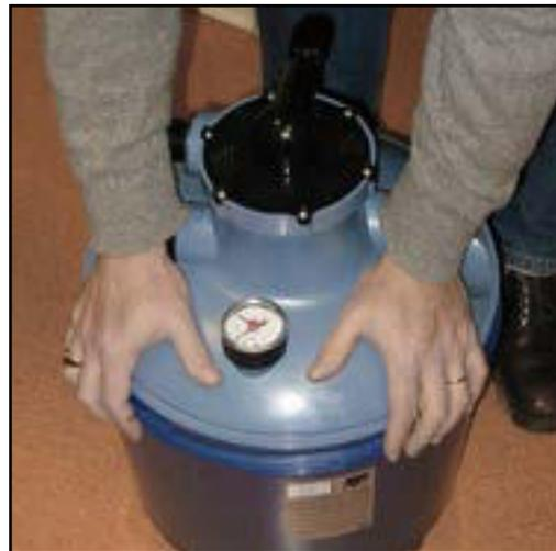
Drücken Sie den Deckel mit beiden Händen gleichzeitig auf den Filtertank. Der Druck auf den Deckel muss aufrechterhalten werden, bis der Dichtring festgeschraubt wurde.
