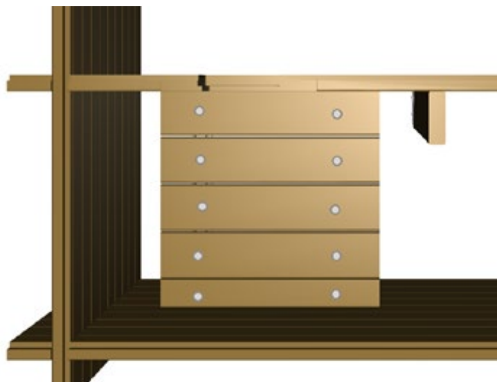
Abbildung 15 – Montage des Box-Bodens
