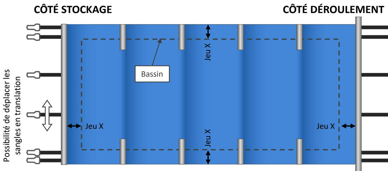
Il est important de bien répartir les sangles pour ne pas déséquilibrer la fixation de la couverture. Le serrage doit également être équilibré de part et d'autre de la couverture.
