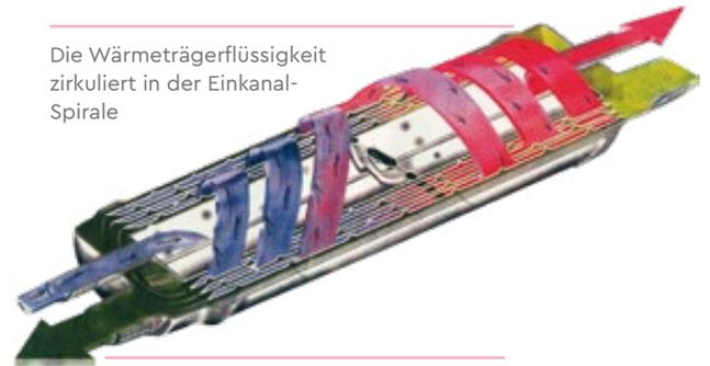
Die Wärmeträgerflüssigkeit zirkuliert in der Einkanal-Spirale
