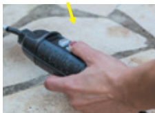
3. Presione el botón «TEST» ; El indicador se desactiva.
