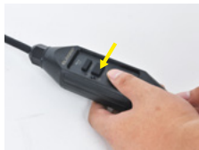
2. Drücken Sie die Reset-Taste, die Anzeige leuchtet auf.
