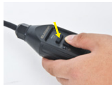
3. Drücken Sie die Test-Taste, die Anzeige erlischt.
