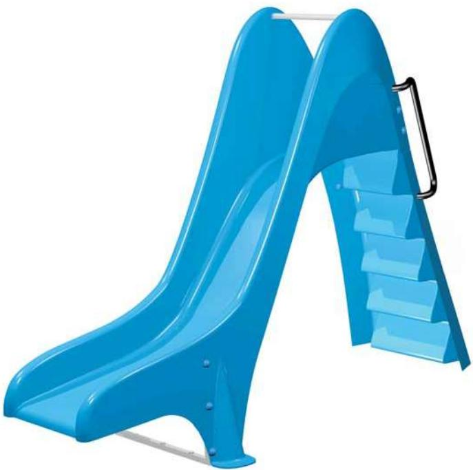
**E** Tobogán de 1,25 m. de altura de plataforma y 1,96 m. de altura total. Por la barra de seguridad sale agua para mantener la pista mojada. Escalera con peldaños antideslizantes y asas de aluminio. Toma rápida para manguera. Fabricado en PRFV con protección UV.
