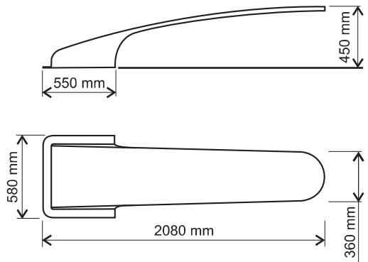
(E) Trampolín fabricado en poliéster y fibra de vidrio, con grabado antideslizante en la superficie. Alta resistencia al desgaste y a los rayos U.V. Se suministra con anclajes.
